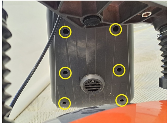
Avaa rungon etuosan takakatteen kuusi kiinnitysruuvia. (ristipäämeisseli ph2).
