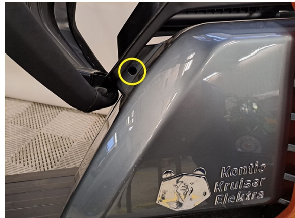
Irrota vasenta kylkipaneelia pitävä kiinnitysruuvi. (ristipäämeisseli ph2).
