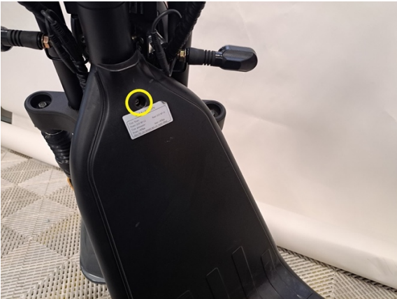
Avaa rungon etuosan takakatteen kiinnityspultti. (kuusiokoloavain 5 mm).
