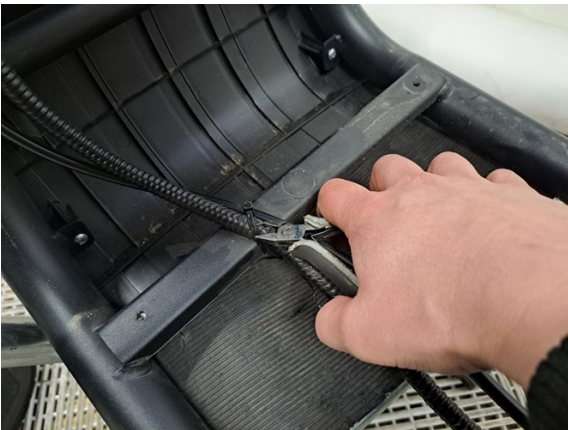
Katko kaikki johtosarjaa kiinni pitävät nippusiteet. (sivuleikkurit).
