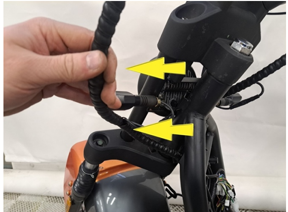
Vedä etupään johdot vapaaksi pidikkeistä kummaltakin puolelta.
