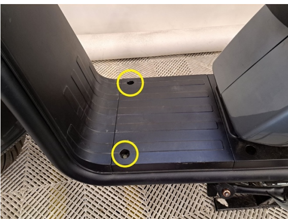
Avaa jalkatilan päällyskatteen kiinnityspultit. (kuusiokoloavain 5 mm).
